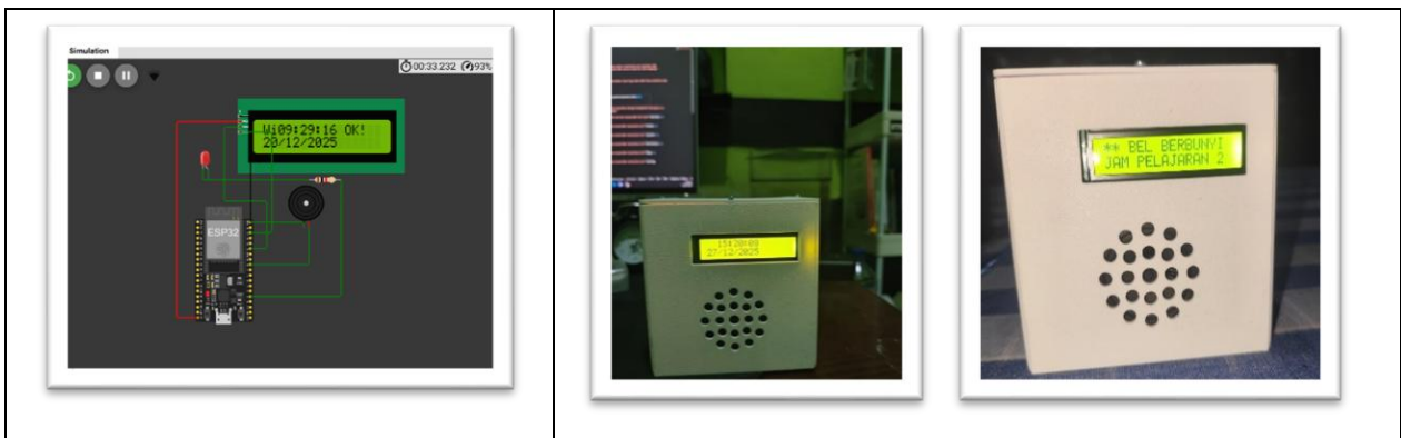
Gambar 3. Sistem Bel dan Bel Bekerja Dengan ESP32
