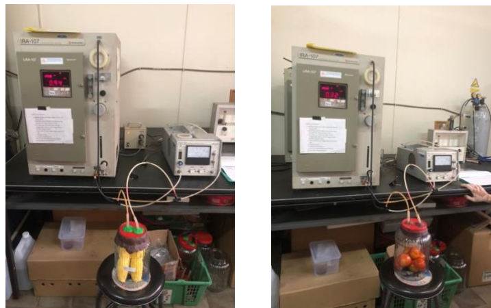
Gambar 6 Pengukuran Laju Respirasi CO_2 dan O_2 Sample
