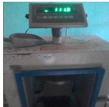
Gambar 2.22 Proses pengujian kuat tekan beton
