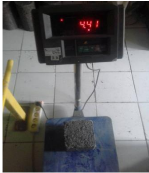
Gambar 2.18 proses pengujian berat jenis beton
