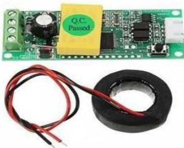
**Gambar 1. Modul Sensor PZEM 004T**
