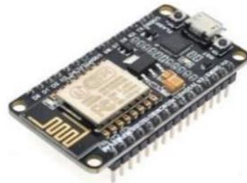
**Gambar 2. Modul NodeMCU ESP32**
